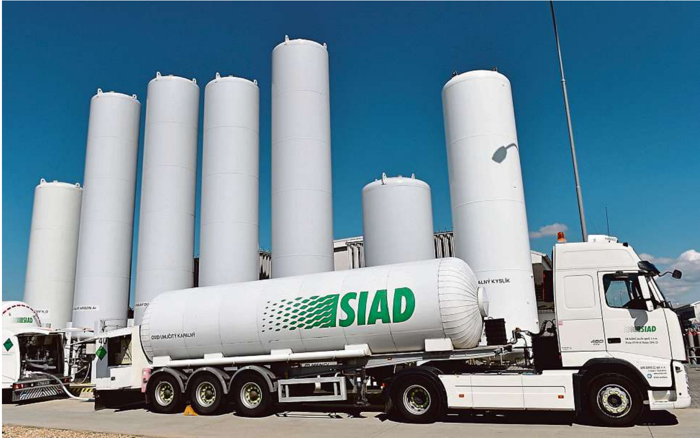
Tekutý plyn Izolovaný oxid uhličitý je třeba převážet i ukládat v takzvaném superkritickém stavu, kdy se hustota blíží kapalině. Foto: Václav Šálek, ČTK
