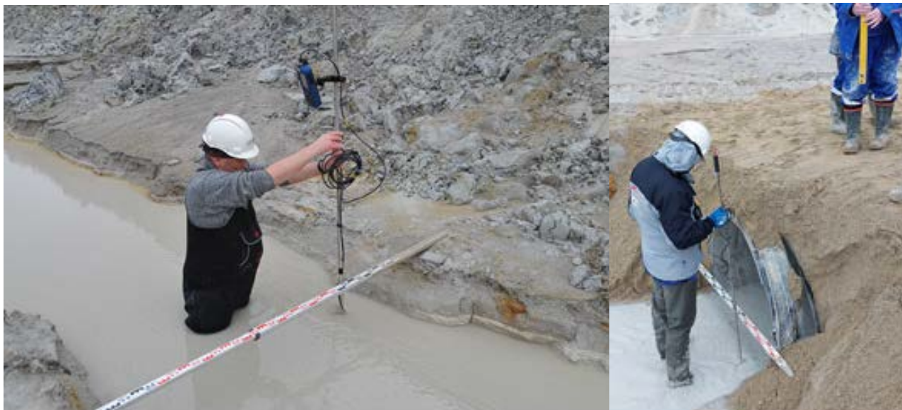
Obr. 2. Fotodokumentace hydrometrování množství odtékající vody (směs povrchové a podzemní vody) z vybraných etází T3 a T2
