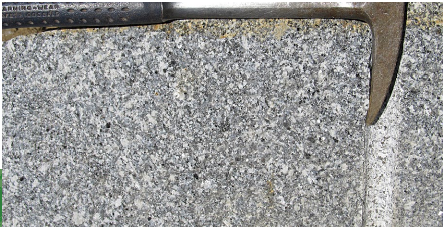
Obr. 14. Lužický biotitický granodiorit, středně zrnitý.
