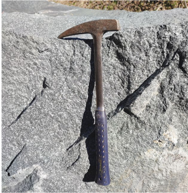
Obr. 13. Tmavý dolerit s typickou ofitickou strukturou, tvořenou lištami plagioklasů a tmavými minerály.
