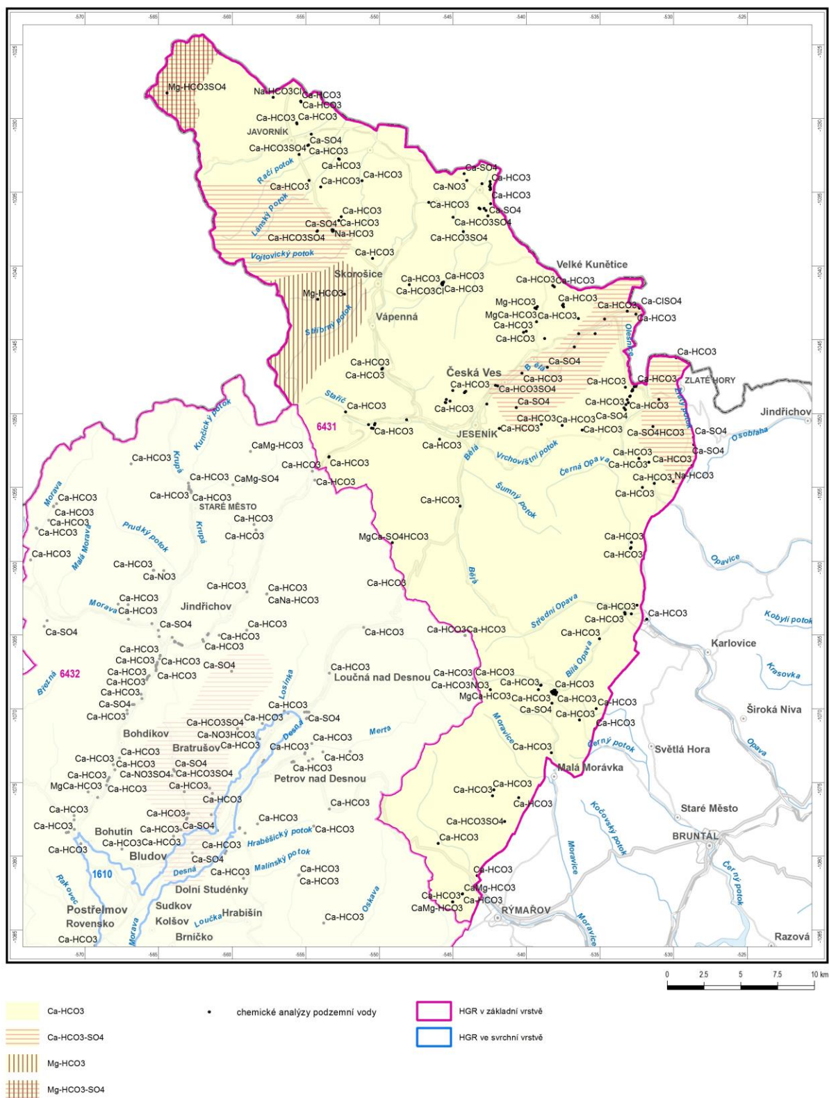
Obr. 4-11. Chemický typ (35 meq%) podzemní vody v HGR 6431
