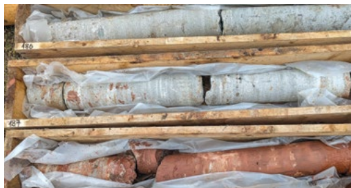
↗ Litologický přechod do tzv. „červeného permu“ je vizuálně patrný výraznou změnou barvy světlých pískovců a arkóz do červenohnědých odstínů permských jílovců, což bylo způsobeno oxidací železa v sušším kontinentálním klimatu. Foto J. Holeček.
