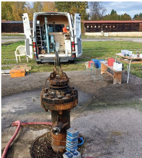
⚡ Odběr vzorku vody a plynu z hloubky 1 400 m ve vrtu LTV-1. Foto A. Tým.
