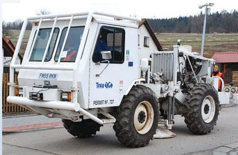
⚙ Vibroseis – zdroj seismického vlnění.
