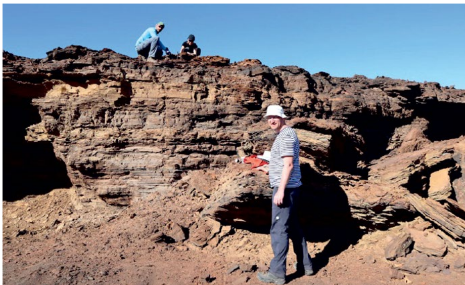
« Detail přetěžovaných starých hald na ložisku Namib Lead and Zinc v Namibii. Granulometrická stratifikace hald vzniká při přemísťování potrubí přesouvajících flotační rmut podél obvodu odkaliště. Foto B. Kříbek.
