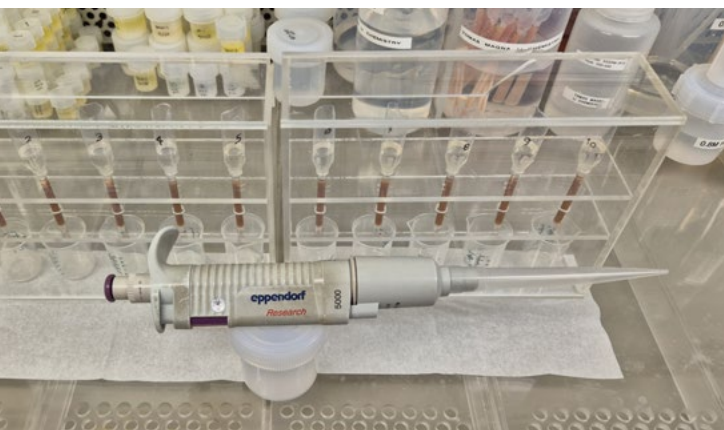
⚡ Chromatografické kolony pro separaci zájmových prvků z horninové matrice. Foto T. Magna.
