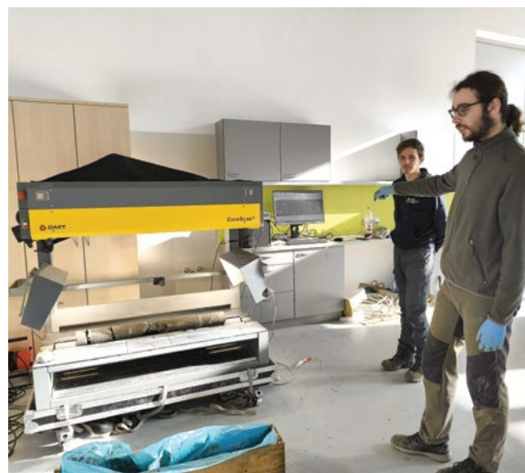
⚡ Skenování a digitalizace vrtného jádra. Laboratoř Ringen, Litoměřice. Foto A. Tým.
