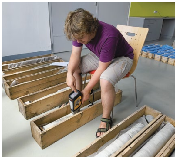
⚡ Spektroskopické měření na vrtném jádře. Vrtný sklad RINGEN, Litoměřice. Foto A. Tým.
