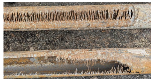
↗ Detail „probroušené“ vrtné tyče. I poměrně silná stěna vrtné tyče z houževnaté oceli nevydržela tření o stěnu vrtu při nadměrném pohybu. Foto J. Holeček.
