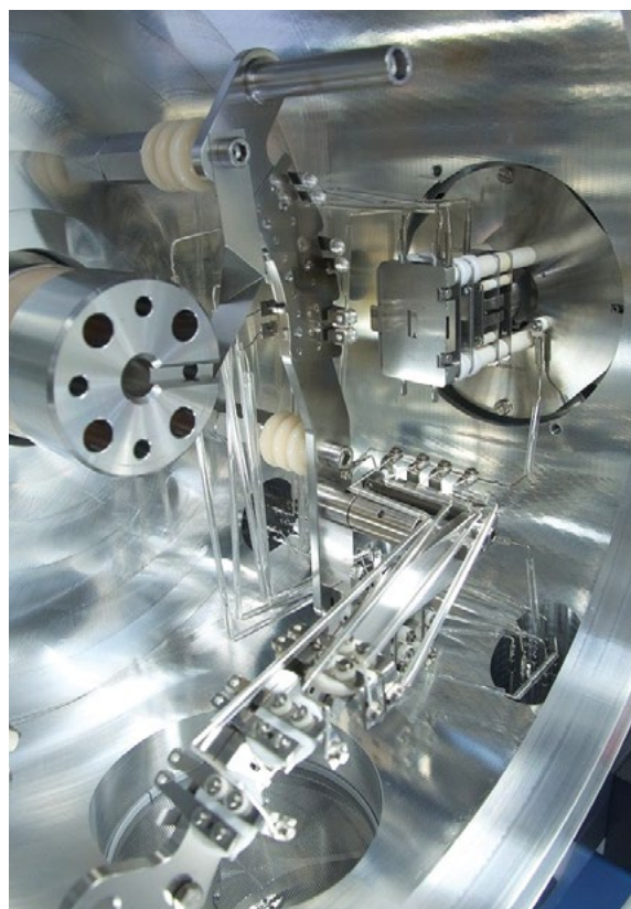
➤ Komora hmotnostního spektrometru s termální ionizací (TIMS) s připravenými vzorky k měření. Foto F. Laufek.
