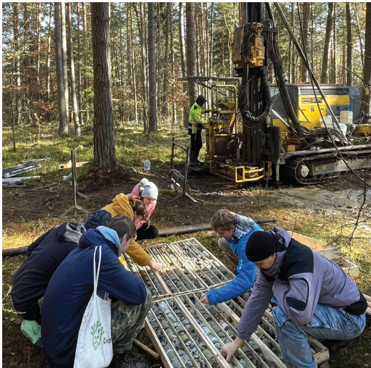
⤵ Vzorkování vrtných jader na Křemži. Foto M. Kubeš.
