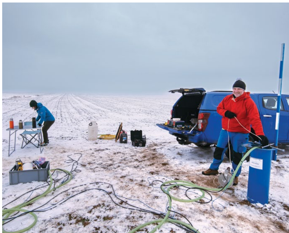
« Čerpací zkouška na vrtu Litovany v rámci projektu Podzemní voda v krystaliniku . Foto R. Hadacz.
