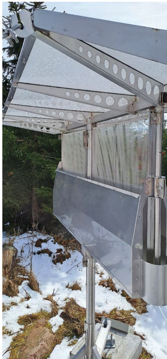
➤ Detail pasivního odběrného zařízení horizontálních srážek – Orlické hory. Foto J. Čuřík.
