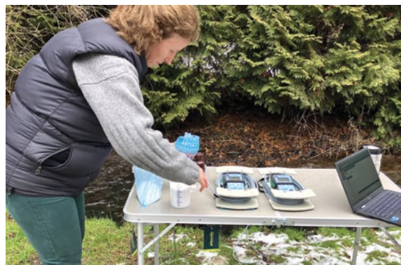
➤ Měření průtoků pomocí chemické metody a přístrojů Sommer TQ Tracer. Na základě množství stopovače a měření konduktivity program okamžitě vyhodnocuje naměřený průtok. Foto I. Kůrková.
