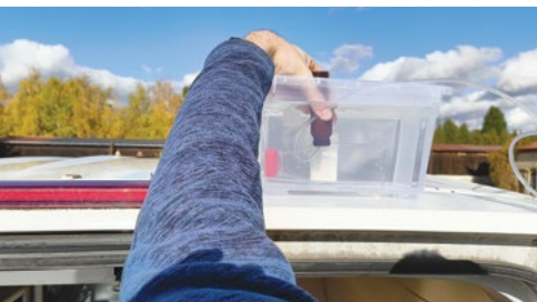
↗ Odběr rozpuštěného plynu do vzorkovnice. Vrt LTV-1, Litoměřice. Foto A. Tým.
