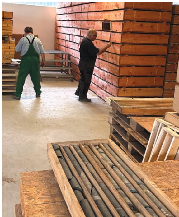
↗ Příprava ukládací stěny ze vzorkovnic ve skladovém areálu Lužná. Foto Z. Veselý.
