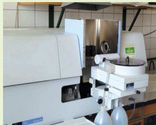
^ AA spektrometr s elektrotermickou atomizací Perkin Elmer AAnalyst 700.
