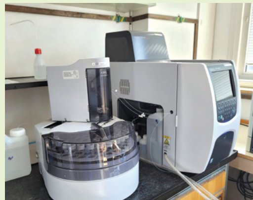
^ Analyzátor TOC-L s TNM-L Shimadzu.
