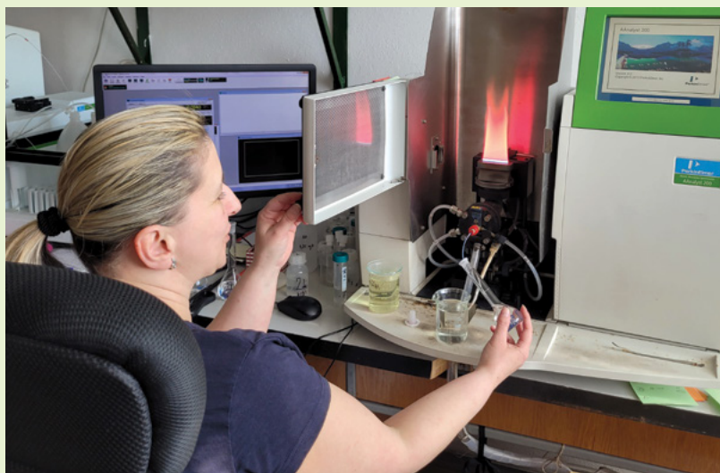
▲ Plamenový AA spektrometr Perkin-Elmer AAnalyst 200.
