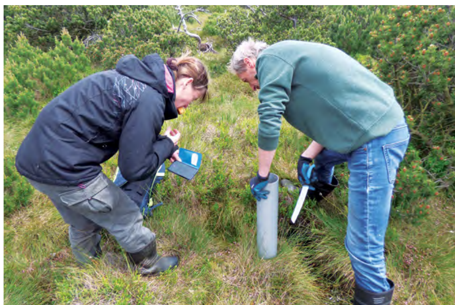
Peat core sampling at the Hora Svatého Šebestiána Bog in the Krušné hory Mts. Photo by M. Štěpánová.
