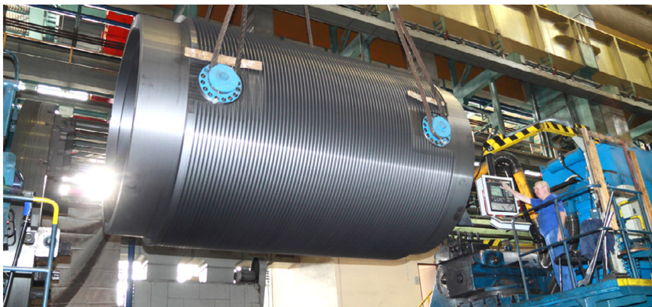
Sud na ukládání středněaktivního radioaktivního odpadu v přepovrchovém úložišti.
