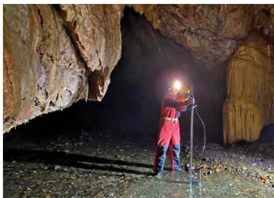
Hydrometrování Jedovnického potoka v Rudickém propadání. Foto R. Hadacz.
