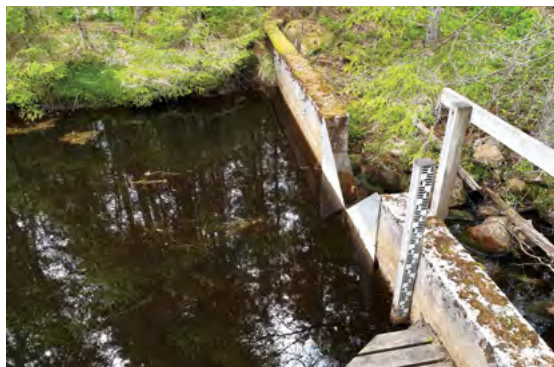
Měrný přeliv pro měření průtoků v závěrové části norského výzkumného povodí Birkenes. Foto J. Čuřík.
