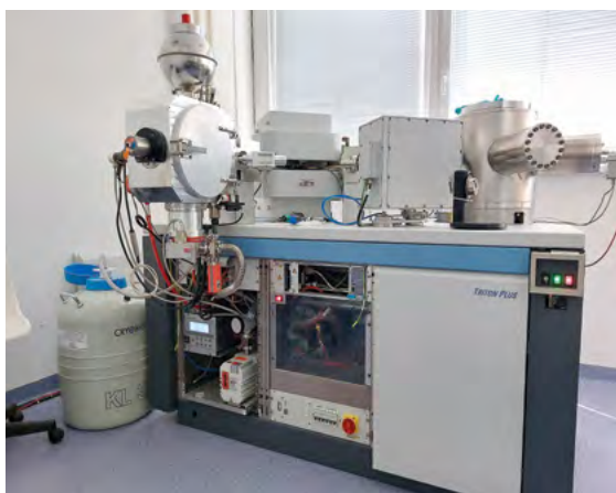
Laboratoř hmotové spektrometrie používá moderní přístroj Triton Plus k vysoce přesným stanovením izotopového složení stroncia a neodymu. Foto T. Magna.
