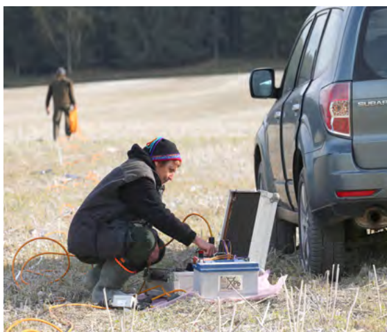
Terénní geofyzikální měření metodou elektrické odporové tomografie (ERT). Foto V. Žáček.
