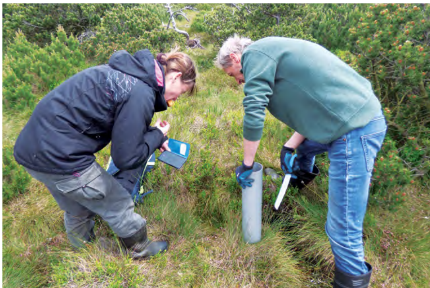
Odběr rašelinného jádra na rašeliňišti Hora Svatého Šebestiána v Krušných horách. Foto M. Štěpánová.
