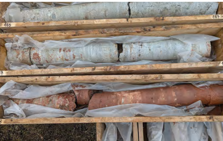
Vrtné jádro nově budovaného 500 m hlubokého geologického vrtu na lokalitě Litoměřice. Úsek vrtného jádra v metráži 186–189 m ukazuje přechod ze světlých křídových sedimentů do červených permských jílovců. Foto J. Holeček.
