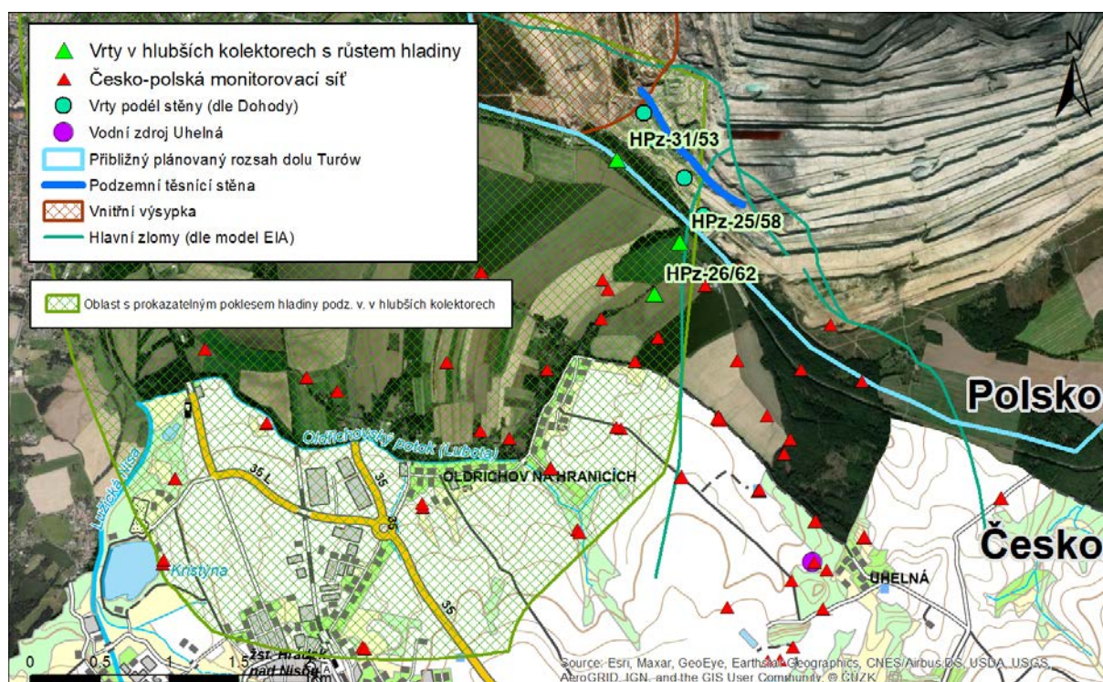
Obr. 4: Umístění vrtů s nárůstem hladiny podzemní vody za poslední rok mezi podzemní těsnicí stěnou a státní hranicí ČR/PR.
