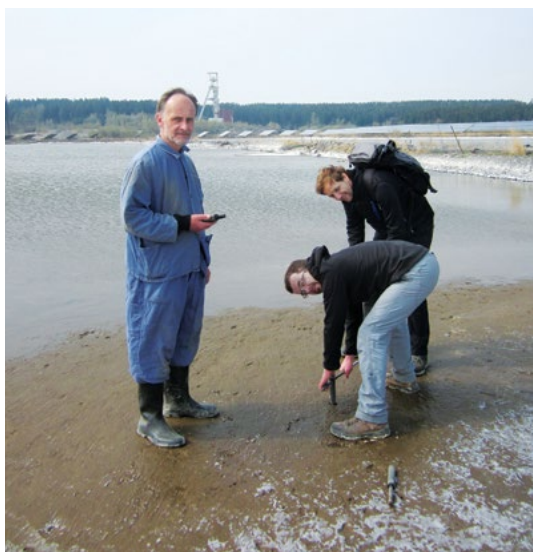
Odběr kalů po alkalickém loužení uranových rud uložených na K-1 z úpravy na ložisku Rožná. Foto B. Kříbek.
