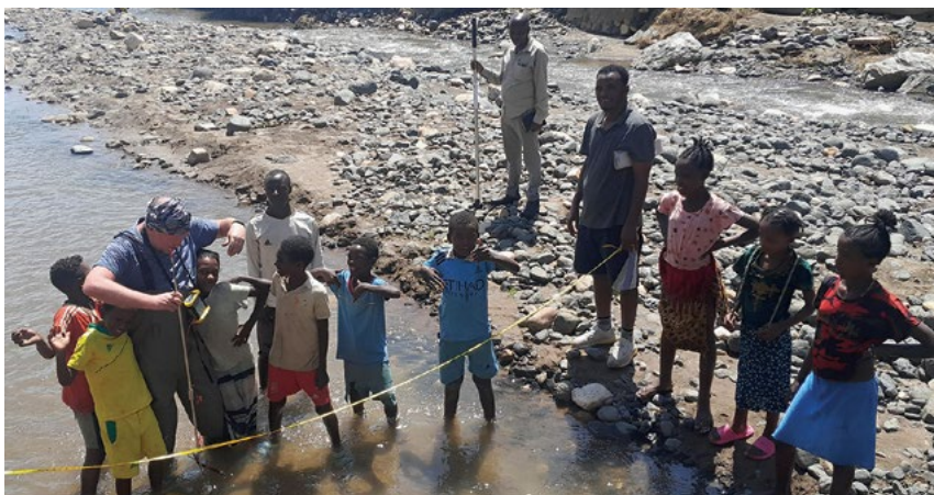
Měření průtoku na řece Loma v Etiopii pro sestavení hydrologické bilance oblasti. Foto J. Jelínek.
