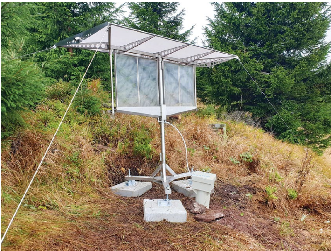
Pasivní odběrné zařízení horizontálních srážek – Orlické hory. Foto J. Čuřík.
