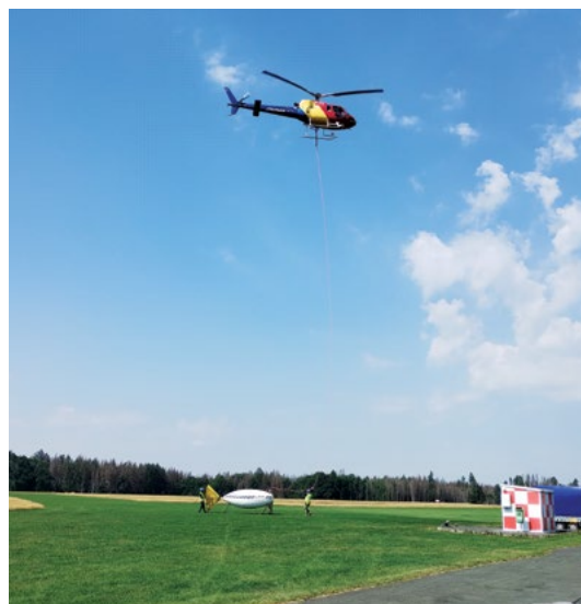
Projekt SEMCRET, letecká geofyzika: FTMG detektor se využívá k vyhledávání mineralizovaných struktur. Foto V. Wertich.
