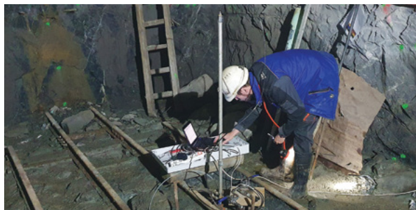
► Realizace vodních tlakových zkoušek v Podzemním výzkumném pracovišti Bukov II v dole Rožná. Foto J. Holeček.
