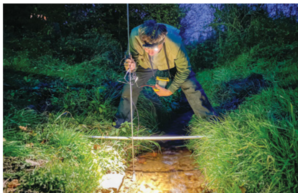
► Měření průtoku řeky Oslava hydrometrováním. Foto R. Hadacz.
