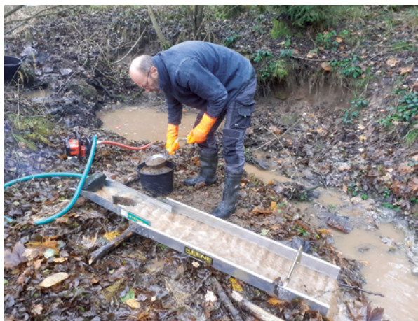
► Odběr velkoobjemového šlichového vzorku při studiu asociací těžkých minerálů. Foto M. Poňavič.
