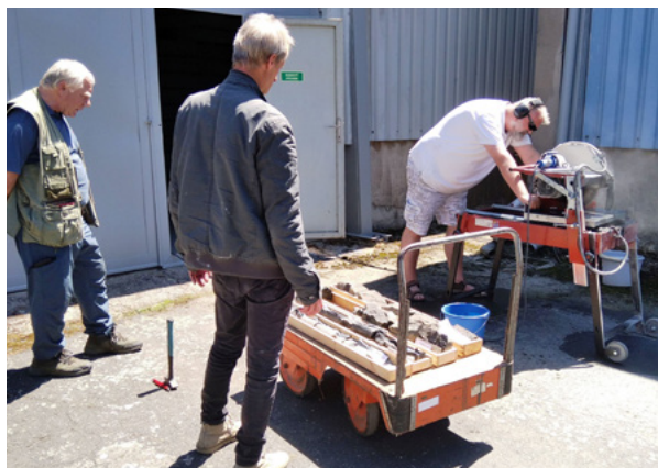
► Hmotná dokumentace: Odběr vzorků z vrtných jader z oblasti Starého Ranska (depozitní sklad ČGS Stratov).
