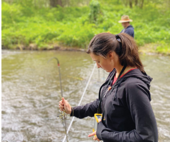
► Měření průtoku řeky Rokytná hydrometrováním, projekt PERUN. Foto R. Hadacz.
