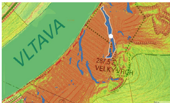
► Bílým polygonem je na podkladu digitálního modelu reliéfu 5. generace (© ČÚZK) ve formě sklonitosti svahů generalizovaným způsobem vyznačeno území skalního říčení v NPR Větrušická rokle. Modrými plochami je vyznačena část terénu se sklonem svahu v rozsahu 50–90°, tedy s potenciálním výskytem dalších skalních říčení.
