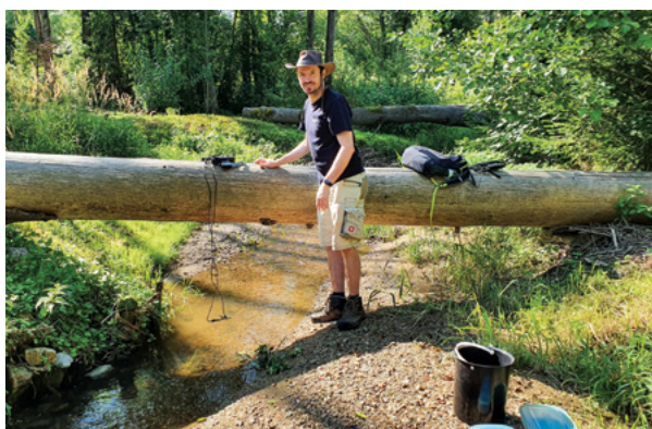
▲ Měření průtoku potoka Kyselá voda u Českých Budějovic pomocí metody ředění soli, projekt PERUN. Foto J. Holeček.
