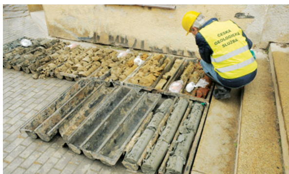
▲ Popis inženýrskogeologického vrtu na ulici Anenská v Brně pracovníky České geologické služby. Foto O. Krejčí.
