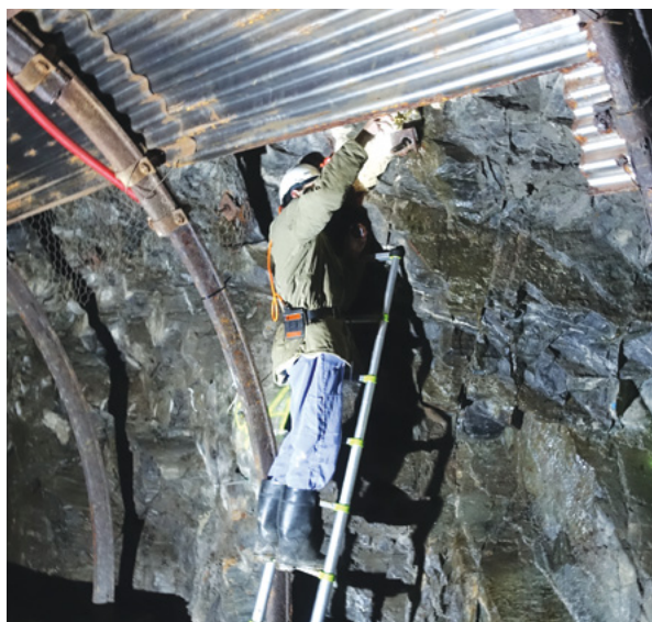
▲ Odběr vzorku podzemní vody z průzkumného vrtu poblíž nově ražené podzemní výzkumné laboratoře SÚRAO v dole Rožná. Foto L. Rukavičková.
