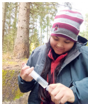
▲ Filtrace vody na povodí Pluhův bor pro analýzu kationtů a stopových prvků. Foto P. Krám.
