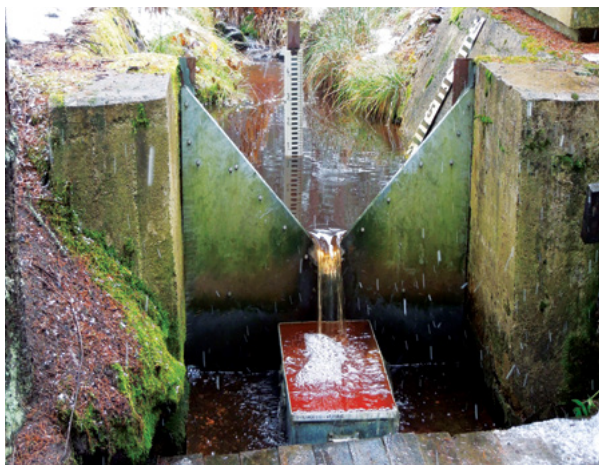
▲ Ostrohranný měrný přeliv na povodí Pluhův bor (hnědá voda v nádobě na měření průtoku je způsobena vysokou koncentrací organického uhlíku). Foto P. Krám.
