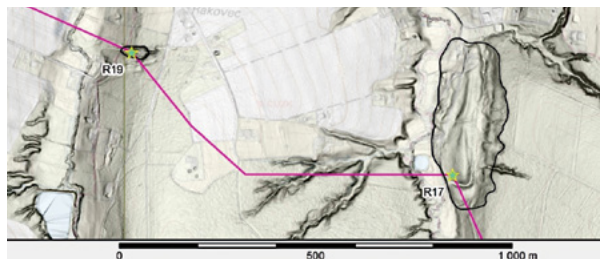
▲ Geomorfologickou analýzou digitálního modelu reliéfu 5. generace (© ČÚZK) byly vymezeny polygony (černé linie) s výskytem geodynamických jevů. Vlevo je patrná erozní deprese se svahy postiženými předpokládanými svahovými pohyby (stožár R19), vpravo pak oblast složené svahové nestability frontálního tvaru (stožár R17).
