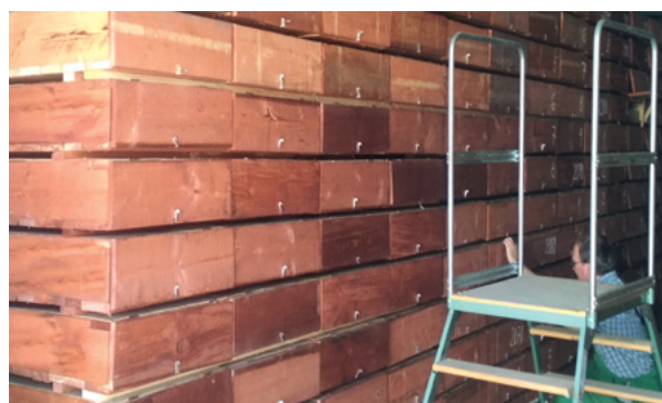
⤴ Systém samonosných vzorkovnic pro trvalé uložení a snadné zpřístupnění vrtného jádra ve skladu hmotné dokumentace v Lužné.
