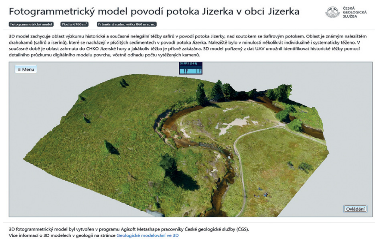
↗ Obrázek 2. Fotogrammetrický model povodí potoka Jizerka v obci Jizerka. Nově vyvinutá metoda webového zobrazení 3D modelu.
