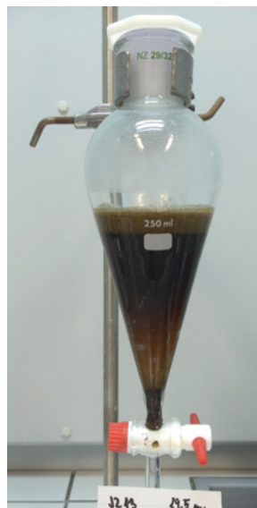
▲ Separace těžkých minerálů v dělící nálevce, těžká kapalina LST. Foto I. Sedláčková.
