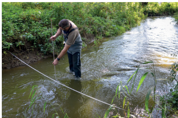
⚡ Měření průtoku řeky Oslavy u obce Sazomín pomocí hydrometrické vrtule připojené na čítač otáček. Projekt Podzemní voda v krystaliniku. Foto A. Havlín.
