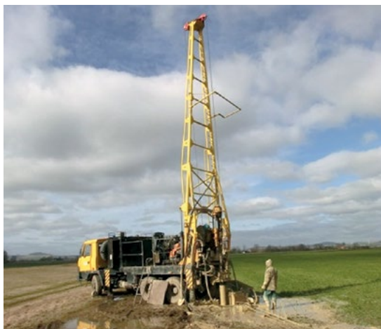
▲ Geologický 3D model podloží pro projekt Turów pomohl umístit hydrogeologický vrt 1420_5 u Oldřichova. Foto R. Nádaskay.
