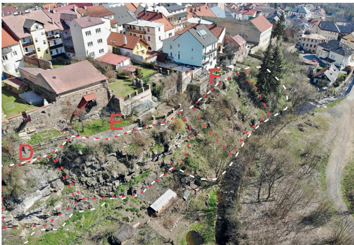
▲ Na snímku skalního svahu ve Vimperku, pořízeném dronem, ohraničuje bílá přerušovaná čára oblast výskytu potenciálních skalních řícení. Červeně vyznačené úseky D a E ohrožují zahrádkářskou osadu, akumulační oblastí pro úsek F je koryto řeky Volyňky. Foto M. Dostalík.
