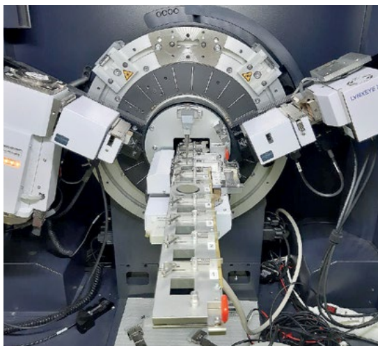
▲ Detail goniometru difraktometru Bruker D8 Advance s automatickým podavačem pro devět vzorků. Foto F. Laufek.
