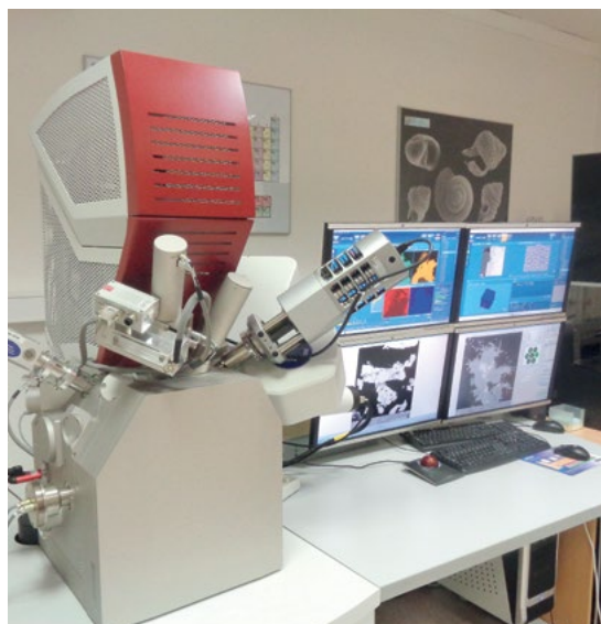
▲ Elektronový mikroskop Tescan Mira3 GMU, vybavený FEG katodou a EDS, WDS, EBSD a CL detektory. Foto O. Pour.
