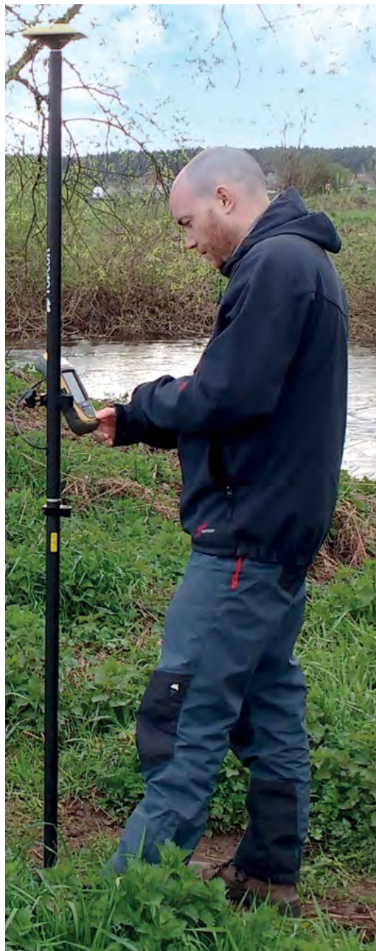
➤ Zaměřování nadmořské výšky říční nivy Jizery u Sojovic v blízkosti jímacích řadů vodárny Káraný pomocí GPS Topcon GRS-1 s přesností \pm 5 cm. Niva je v těchto místech v jarních měsících čas od času zaplavena. Foto I. Kůrková.
