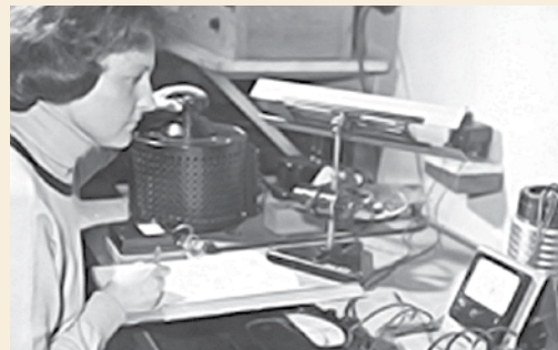
➤ Aparatura DTA k identifikaci jílových minerálů. Foto J. Bárta, 1960.
