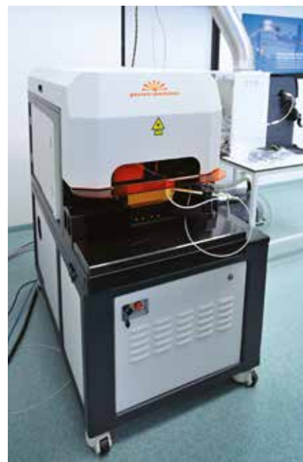
Laserový ablační systém spojený s kvadrupolovým hmotnostním spektrometrem s indukčně vázným plazmatem Agilent 7900 ICP-MS.
