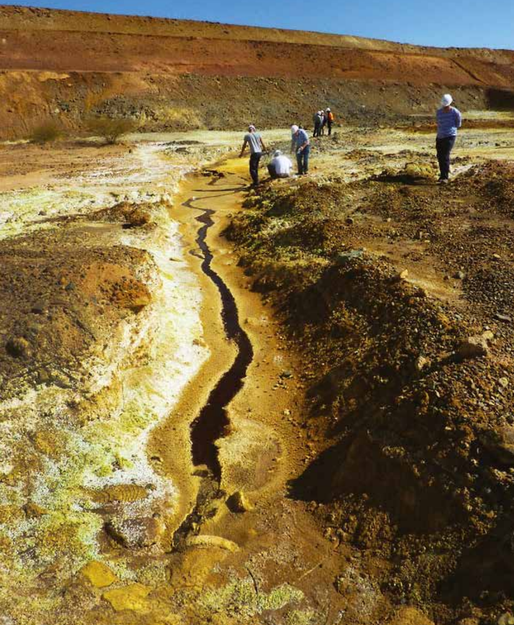
Vzorkování kyselých vod vytékajících z úložiště flotačních odpadů a sekundárních minerálů na ložisku Selebi Phikwe v Botswaně. Vytékající vody jsou velmi kyselé a obsahují vysoké koncentrace kobaltu, niklu a mědi. Foto V. Ettler.
