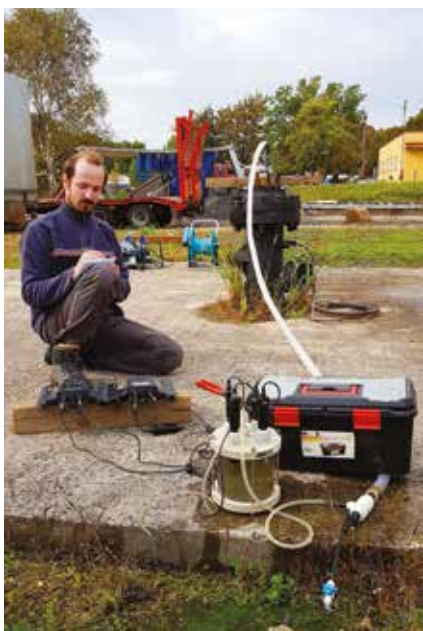
Čerpací zkouška a měření fyzikálně-chemických vlastností podzemní vody na geotermálním vrtu LTV-1 v Litoměřicích.
