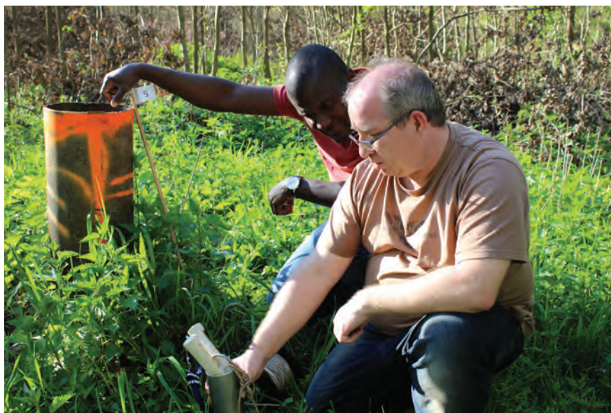
Česko-norské měření vlastností podzemní vody z mělkého akviferu na lokalitě potenciálního budoucího geologického úložiště CO 2 .
