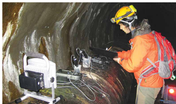
■ Měření chemicko-fyzikálních vlastností podzemních vod ve vodovodním přivaděči Bedřichov. Foto J. Holeček.
