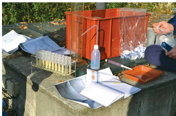
■ Vybavení pro odběr vzorků na stanovení izotopového složení kadmia.
