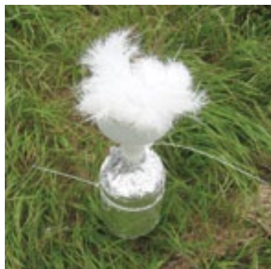
Zařízení na odběr mlh pro izotopovou studii depozice dusíku v rámci projektu GAČR. Lokalita Březník na Šumavě (foto E. Přechová).
