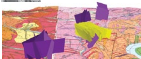
Vizualizace zlomů v rámci granodioritu a tonalitu slapského typu. Fialová – všechny povrchové zlomy, žlutá – zsz.-vjj. strmě uložený zlomový systém v rámci štolového patra.
