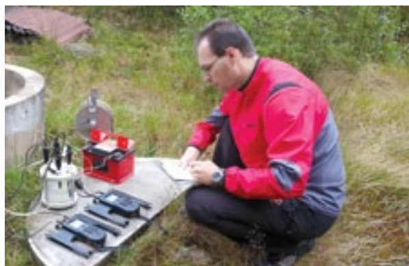
■ Terénní měření fyzikálně-chemických parametrů podzemních vod.
