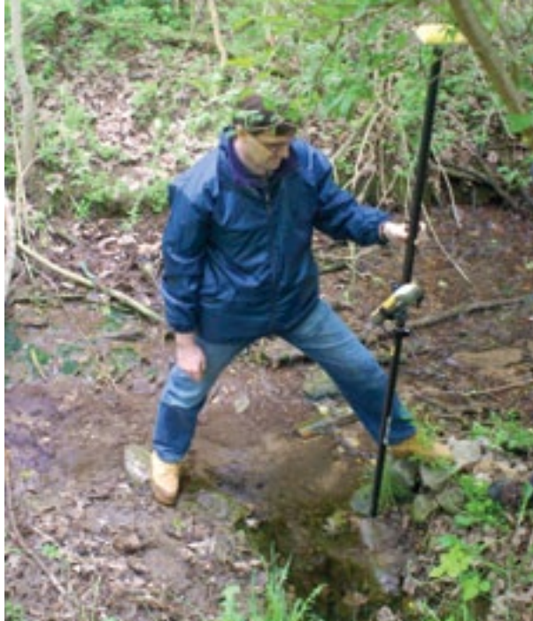
■ Přesné zaměření pramene pomocí GNSS přístroje Topcon.
