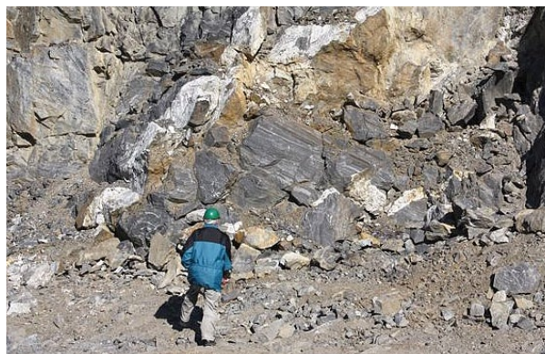
■ Odběr vzorků tmavošedé až zelenošedé biotiticko-amfibolické ruly a amfibolitů ve druhé etáži výhradního ložiska stavebního kamene Polníčka (foto J. Godány).
