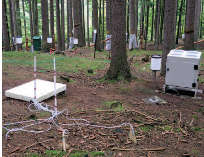
Ukázka rozmístění automatických zařízení na měření podkorunových srážek v povodí Liz.
