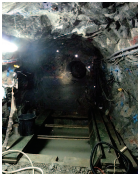
Situace experimentální lokality a instrumentace experimentu ve štole Josef u Mokrska v rámci projektu „Výzkum termální zátěže hornin“. Obrázek dokumentuje lokalitu před izolací širokoprofilového zahřívacího vrtu a okolních monitorovacích vrtů.
