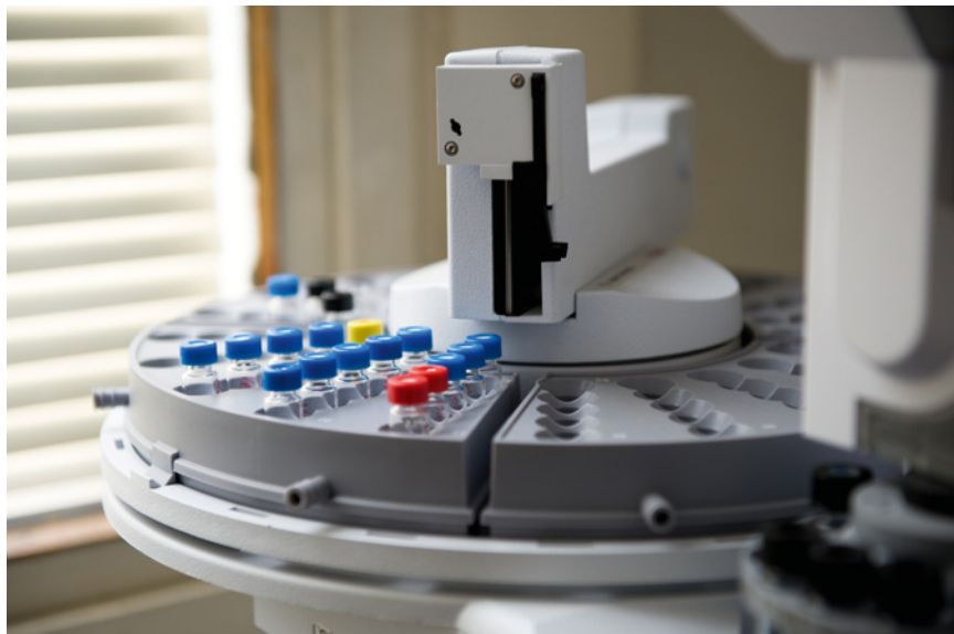
Horninové extrakty biomarkerů připravené k analýze v plynovém chromatografu s hmotnostním spektrometrem.
