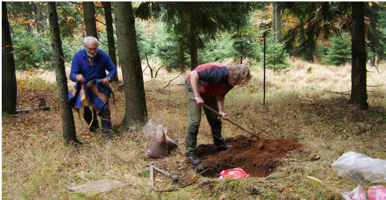
Instalace lyzimetřů pro odběr podzemních vod na lokalitě Říčky v Orlických horách (foto J. Čuřík).
