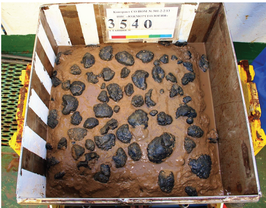
Obr. 7. Odebraný vzorek sedimentu s polymetalickými kongrecemi po vypuštění vody z box-coreru
