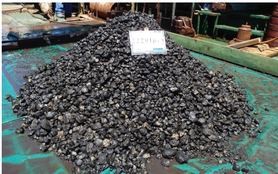
Obr. 9. Velkoobjemový vzorek polymetalických konkrecí odebraný vlečnou sítí v průzkumném bloku H22
