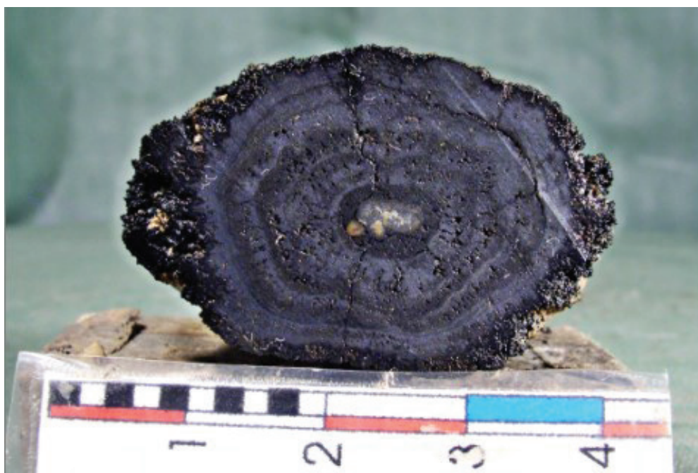
Obr. 10 Vnitřní struktura polymetalické konkrce
