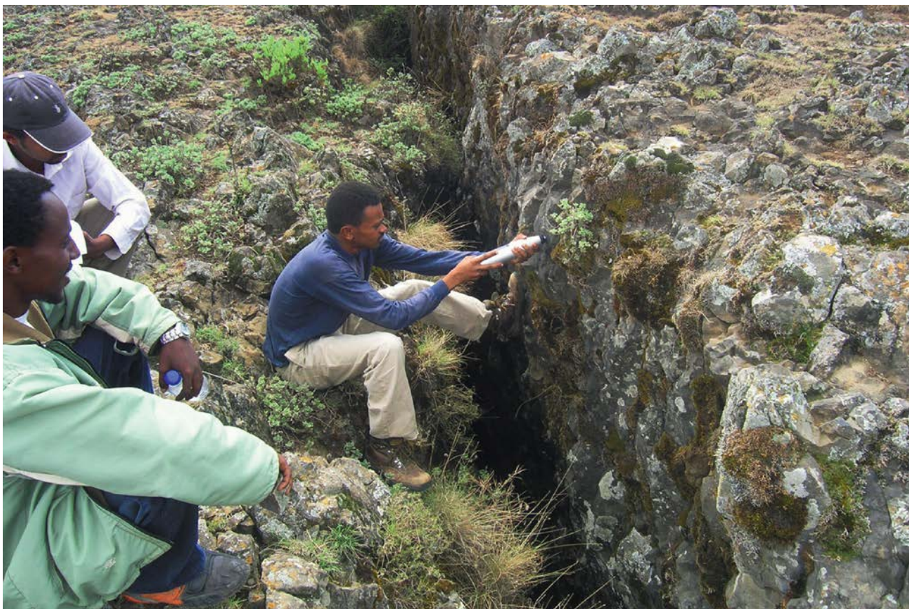
■ Při okraji pánve řeky Jemmy se uvolňuje blok čediče. Pracovník Etiopské geologické služby (Leta) za asistence svých kolegů (Janymar, Esatu) testuje blok čediče Schmidtovým kladívkem. Foto J. Krupička.
