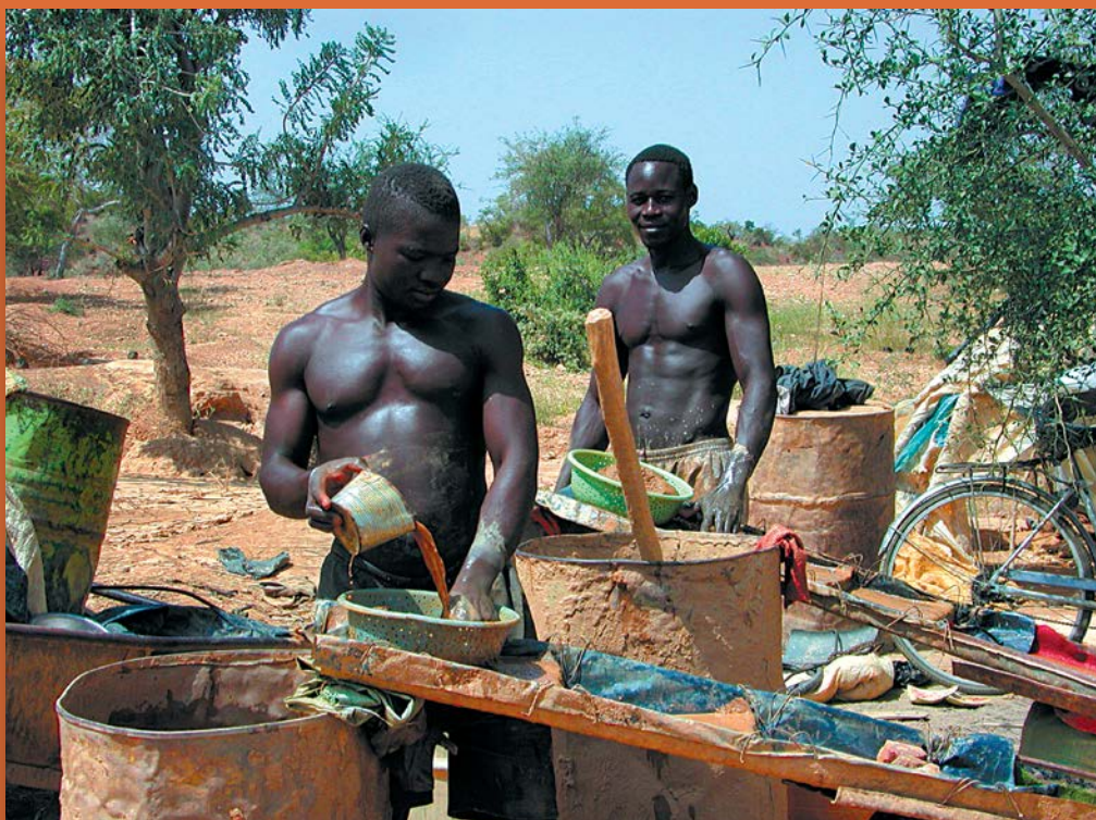
Získávání zlata metodou plavení podrcené rudy na primitivních splavech na lokalitě Pousghin, region Ganzourgou, střední Burkina Faso. Foto J. Pašava.
