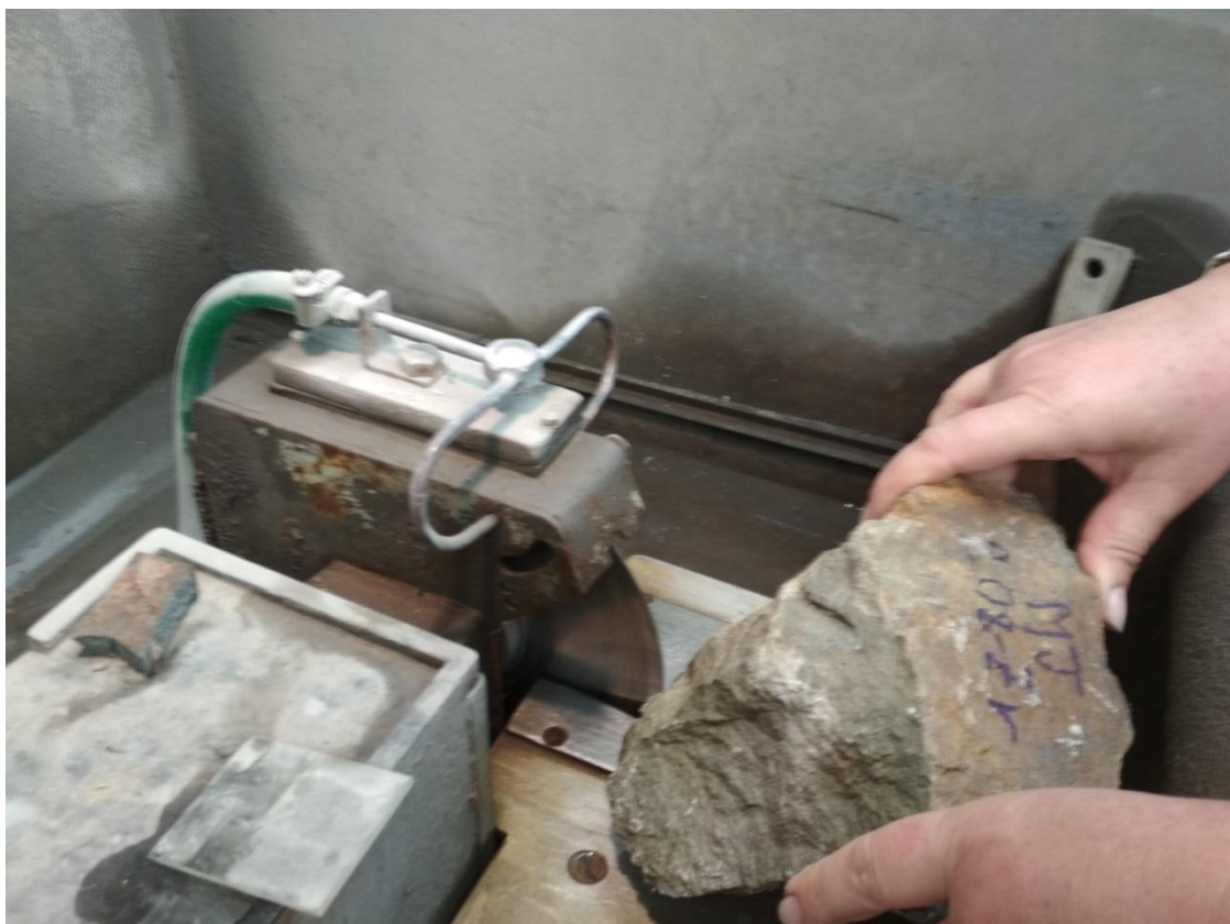
Vzorek o velikosti cca 17x17x13 cm je nemožné na této pile rozřezat.
