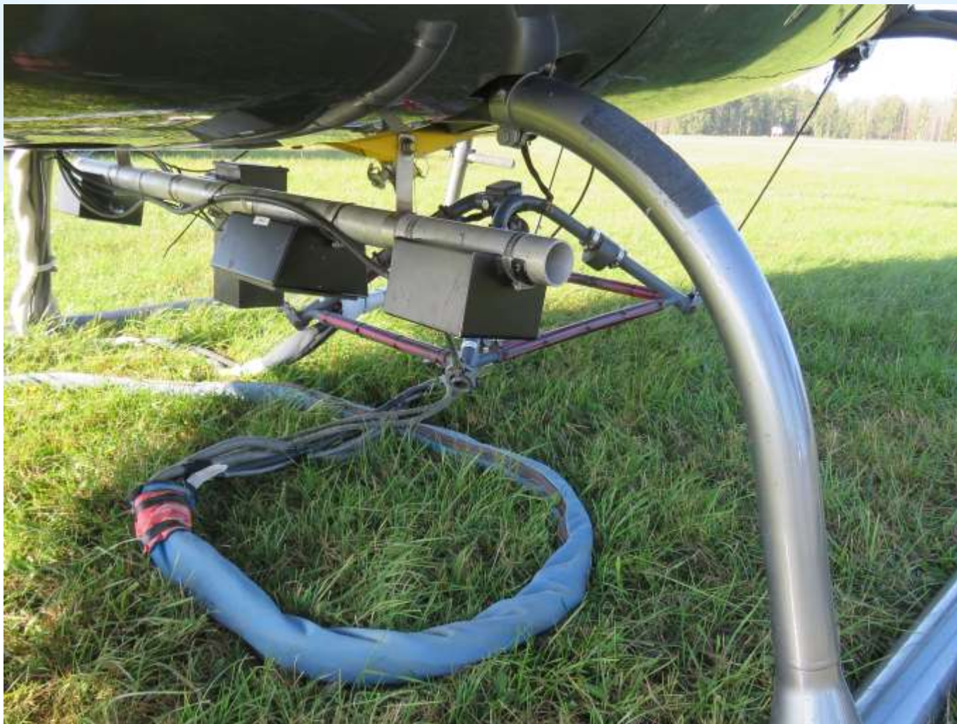
Detail podvěsu se snímací kamerou, laserovými výškoměry a uchycením pro nosná lana a kabeláž antény a magnetometru
