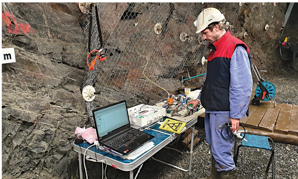
Vodní tlaková zkouška ve vrtu S-27 na 12. patře dolu Rožná v podzemním výzkumném pracovišti Bukov. Foto J. Holeček.
