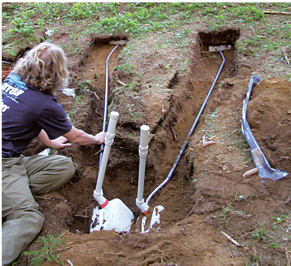
Instalace gravitačních lyzimetrů k odběrům půdní vody ve Slavkovském lese. Foto L. Bohdálková.
