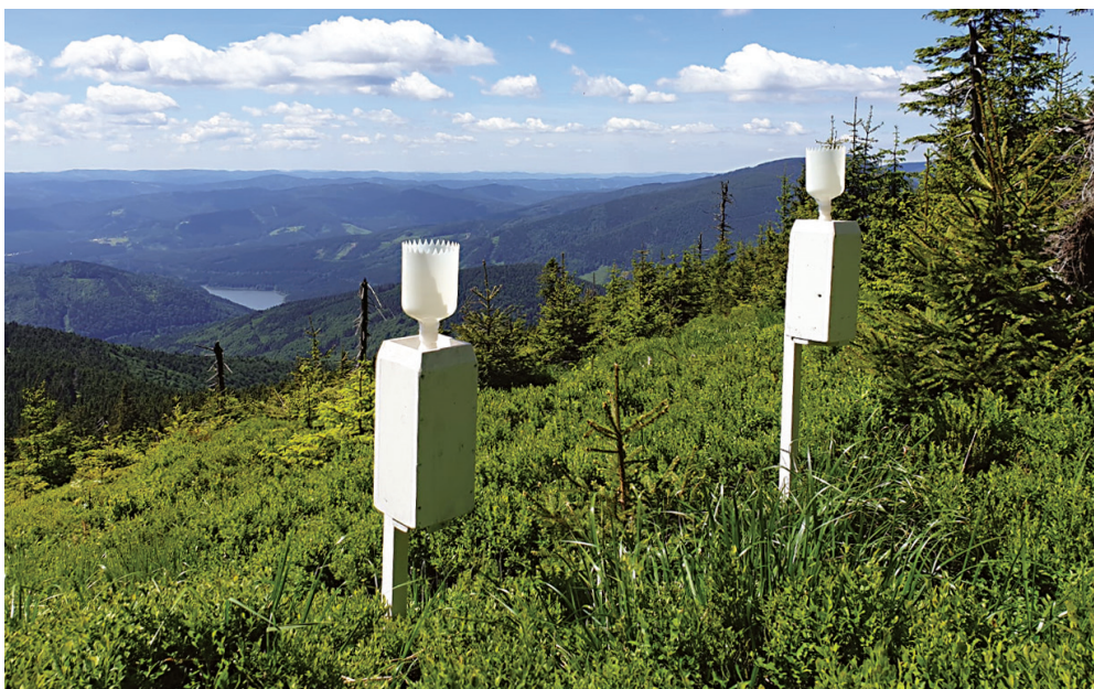
Instalace srážkových odběráků v Beskydech. Foto J. Čuřík.
